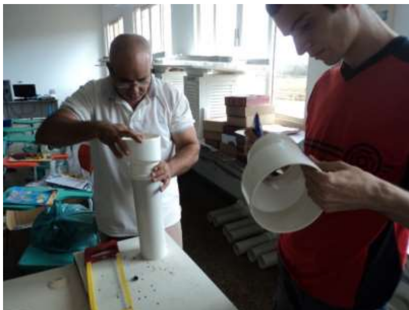
Figura 3: cortes e colagem do pluviômetro de PVC.
