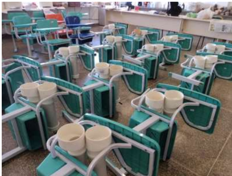
Figura 5 teste de vazamento do pluviômetro de PVC.
