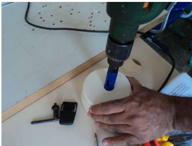
Figura 2: início da confecção do pluviômetro de PVC.
