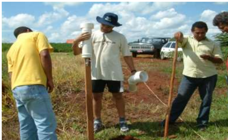
Figura 7 processo de instalação pluviômetro de baixo custo na estação
