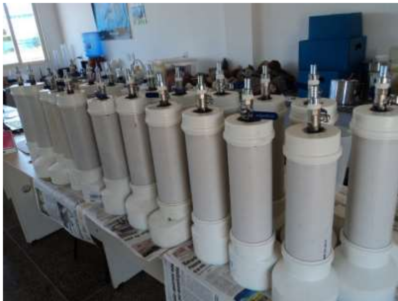
Figura 4: cortes e colagem do pluviômetro de PVC.
