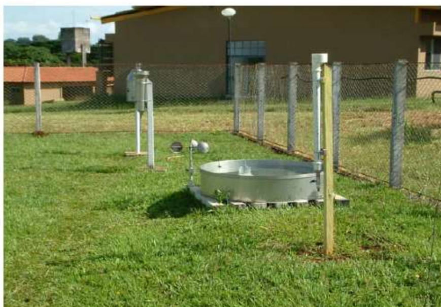
Figura 8 processo de aferição e calibração do pluviômetro de baixo custo.
